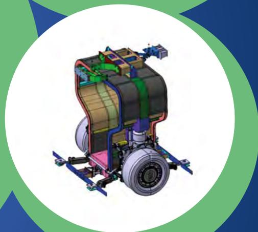
L'oggetto è la realizzazione di un prototipo dimostratore di veicolo articolato per il trasporto urbano passeggeri (trolley bus) con le seguenti caratteristiche principali: guida autonoma, propulsione elettrica, ricarica batterie contactless, articolazione brevettata.
