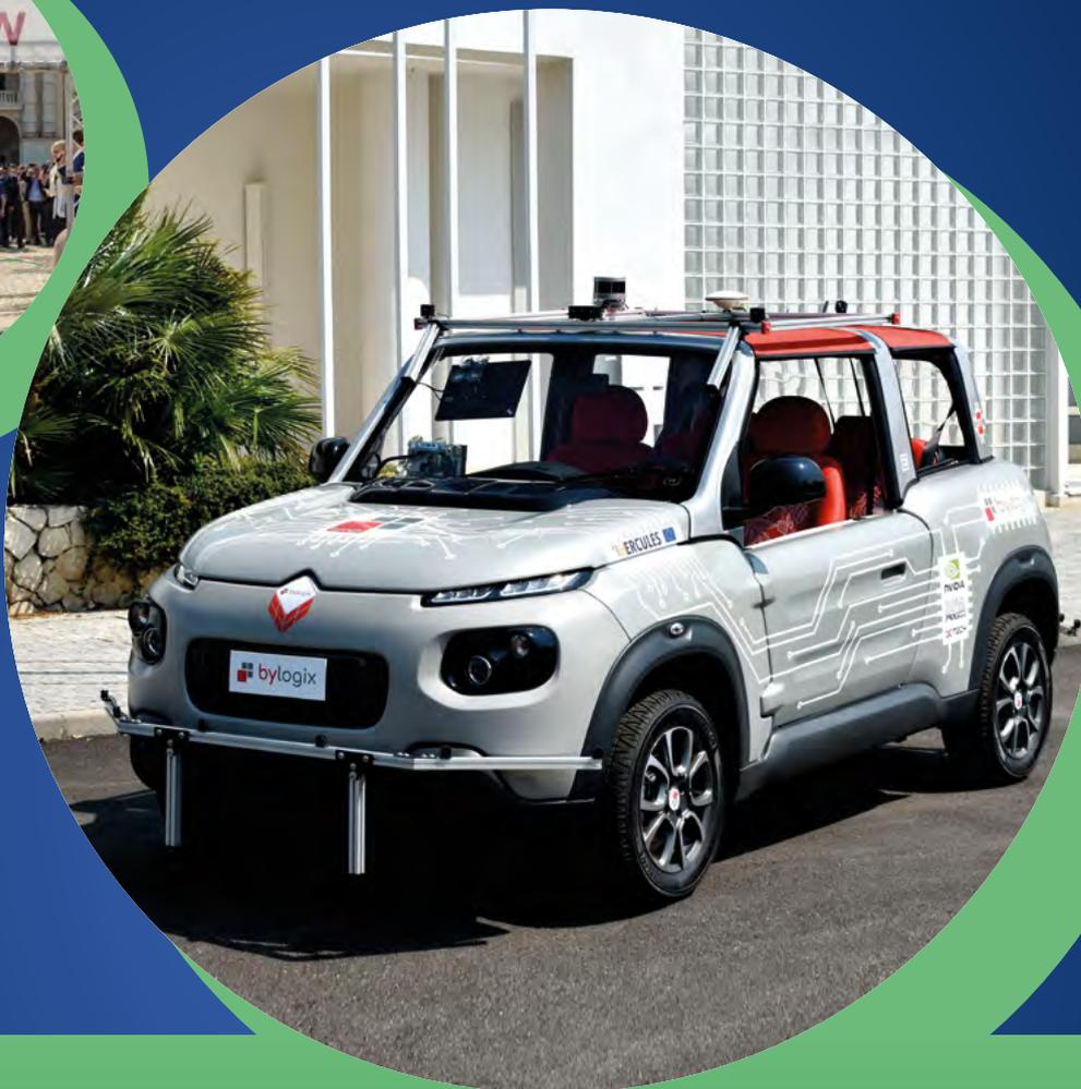
Il progetto **VeGA (Veicolo a Guida Autonoma)** aveva l'obiettivo di sviluppare un sistema elettrico ed elettronico per auto autonome e connesse. È stato realizzato da Bylogix, impresa innovativa di Torino aderente al Polo ICT, che sviluppa software e hardware componenti elettronici integrati.
