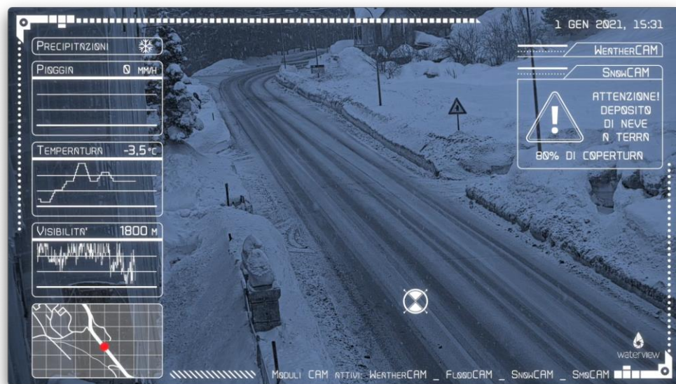
Figura 1 - Pannello di controllo del monitoraggio meteo in tempo reale eseguito sulle smart camera della SS51
